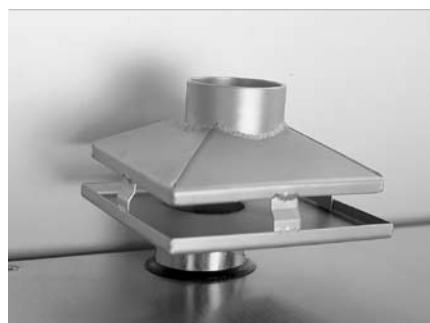
Zabezpieczenie przed spływem kondensatu do urządzenia, typu 61, 101, 62 Spływający z przewodu odprowadzającego parę kondensat jest usuwany przez odpływ z urządzenia.
